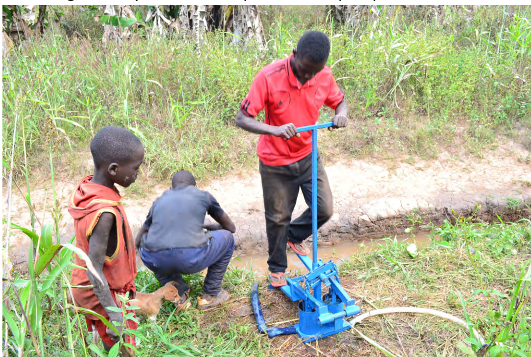
Photo : Technique de pédaler pour faire monter l'eau
